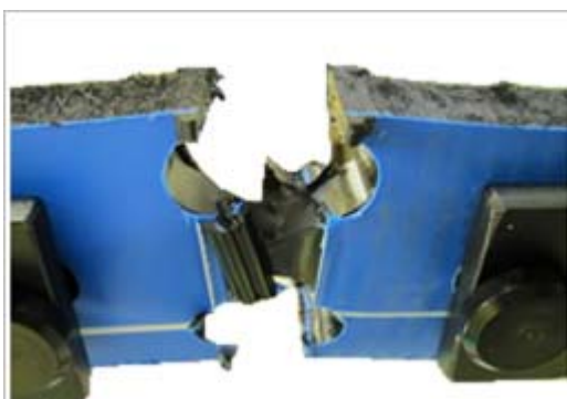
Da vi skiller rørstykkerne ad, flyder stuksvejsning på begge sider af svejsningen. Funktionsmæssigt kan samlingen således godt godkendes.
