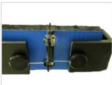
Svejsningen holder ved en træktest med en belastning på 1.3 tons.
